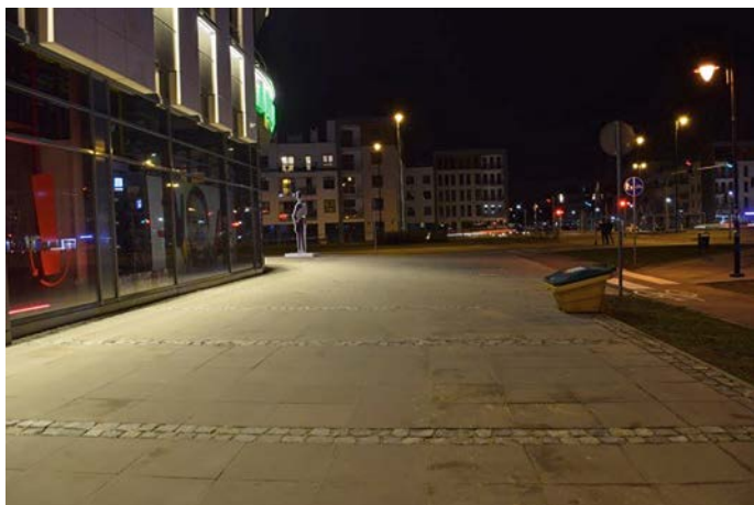
Рис. 3. Высокая яркость дорожного покрытия как нежелательное следствие противоположной направленности ОЗС
