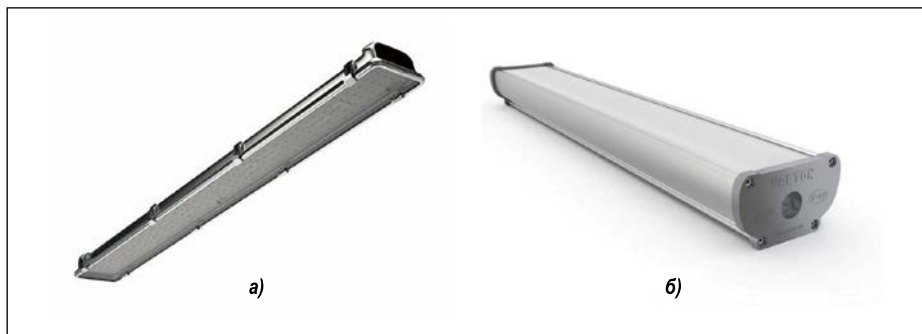
Рис. 1. Светильники с СД для животноводческих комплексов для КРС: а – INOX LED70 (ООО «Световые технологии»): 67 Вт, 7000 лм, 5000К [4]; б – Iron Agro (компания «Вартон»): 36 /54 Вт, 4000/6300 лм, 4000 /6500 К [5]
