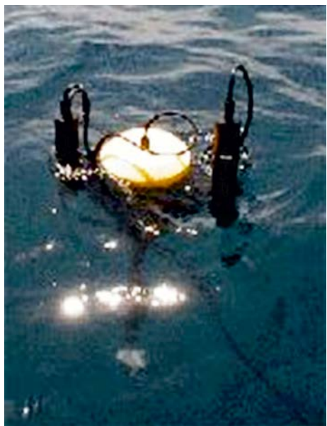
Рис. 6. Измерительная система Profiler II , разработанная компанией SATLANTIC [20], для измерения яркости восходящего излучения и облучённости сверху в 8 спектральных каналах. Слева – модификация для измерений в «буйковом» варианте, справа – измерения в режиме «свободного падения»
