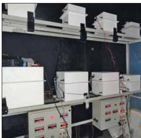
Рис. 2. Стойка для испытаний СД на срок службы
