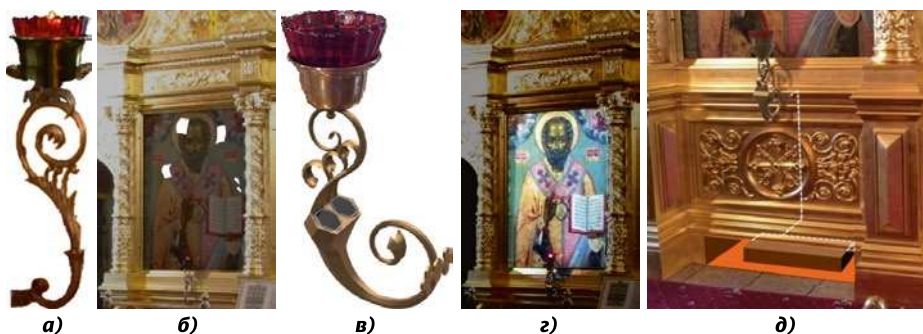
Рис. 21. Модернизация бра-подсвечника: а – конструкция традиционного бра-подсвечника, б – икона при традиционном освещении, в – конструкция модернизированного бра-подсвечника, г – результат при использовании модернизированного бра-подсвечника, д – расположение аккумулятора
