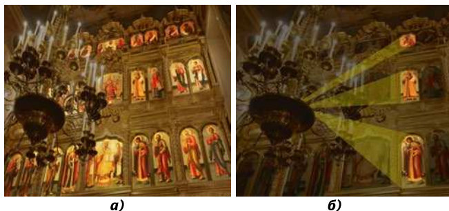
Рис. 25. Внешний вид иконостаса (модель) при освещении его модернизированным паникадилом в режимах музейного освещения: полного (а) и выделения отдельных икон (б)
