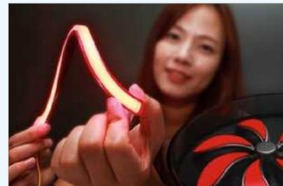
Компания поместила на тонкую подложку большое количество СД, формирующих автомобильный осветительный модуль. Этот модуль представляет собой гексадр, который плавно изгибается, как резина, и устанавливается в наружных огнях, таких как дневные ходовые огни и габаритные задние фонари.
