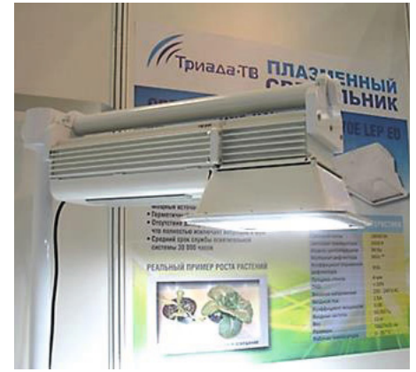
Рис. 31. Облучатель с безэлектродной МГЛ. «Триада-ТВ»
