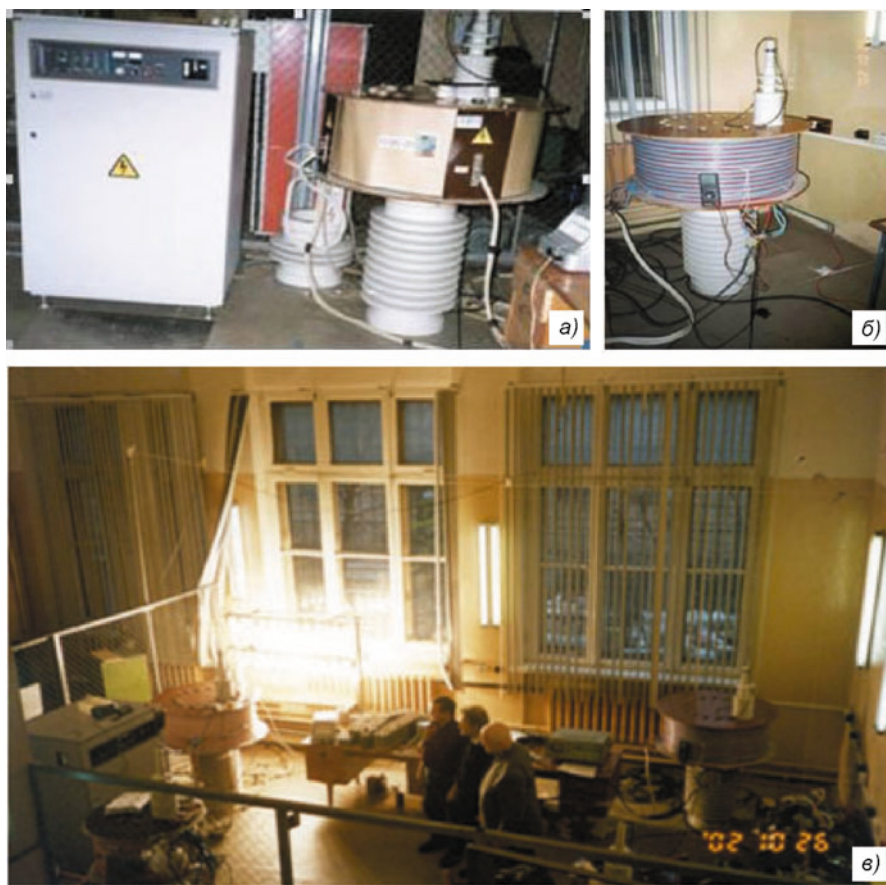
Рис. 2. Преобразователь частоты и резонансный контур передающего ВЧ трансформатора (а). Резонансный контур понижающего ВЧ трансформатора (б). Испытания в ГНУ «ВИЭСХ» резонансной энергетической системы мощностью 20 кВт с однопроводной кабельной линией длиной 1,2 км (в)
