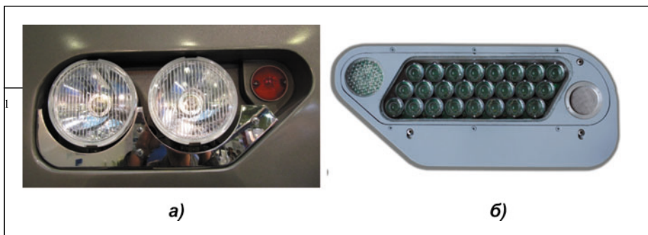
Рис. 1. Блок-фары метropоезда модели 81–760: а – традиционное исполнение; б – опытный образец светодиодной блок-фары
