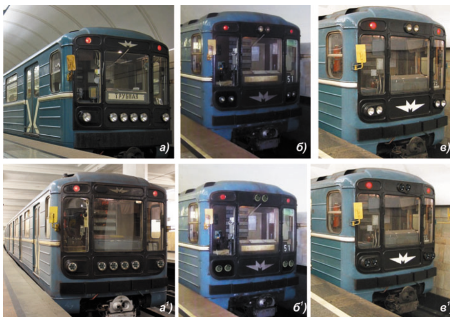
Рис. 6. Размещение традиционных и модернизированных фар на вагонах моделей 81–717, 81–717.5, 81–717.5 М: а – на вагоне 81–717; б – на вагоне 81–717.5; в – на вагоне 81–717.5 М; а', б' и в' – соответствующие модернизированные варианты
