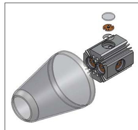
Рис. 11. Фонарь новой конструкции с отрезанным основанием
