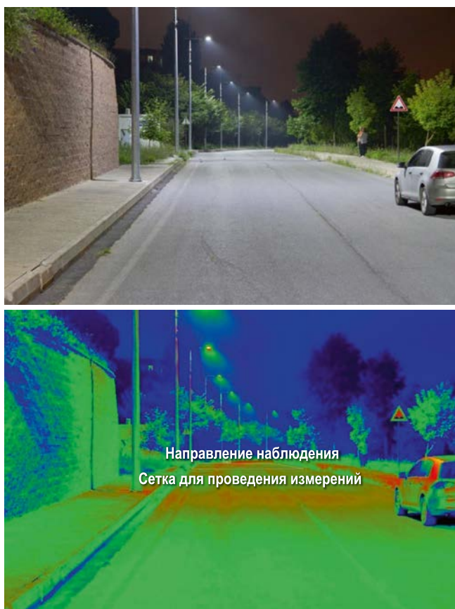
Рис. 4. Полученное яркомером изображение экспериментального участка дороги
