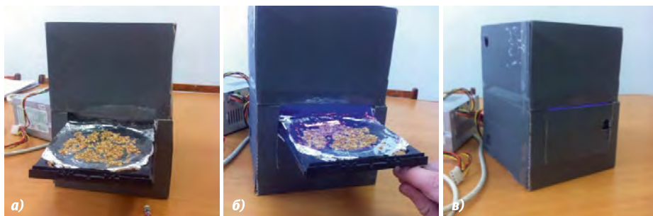
Рис. 4. УФ облучательная установка:
