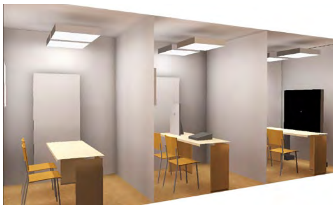
Рис. 6. Моделирование освещения помещений для экспериментальных исследований (в «DIALux»)
