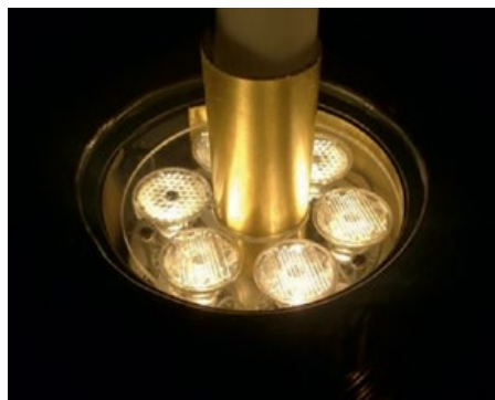
Рис. 7. Варианты рассеивающих структур конвертеров
