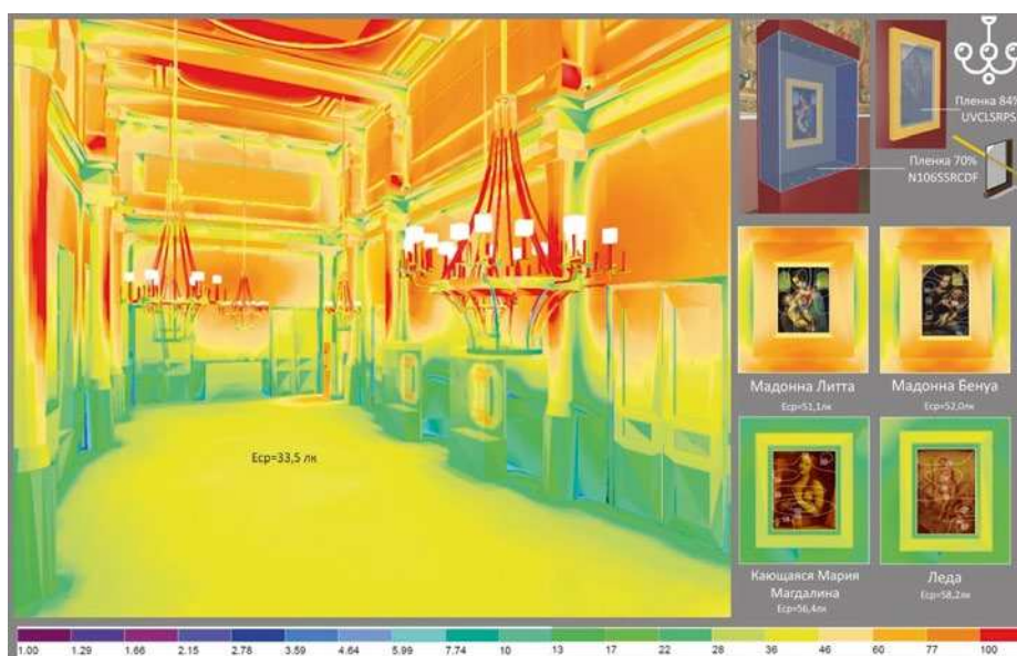
Рис. 10. Расчёт искусственного комбинированного освещения и схема локального затемнения картин
