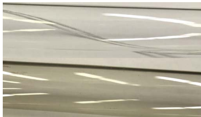
Рис. 3. Кварцевые стенки колбы новой лампы (вверху) и лампы, отработавшей свой срок службы
