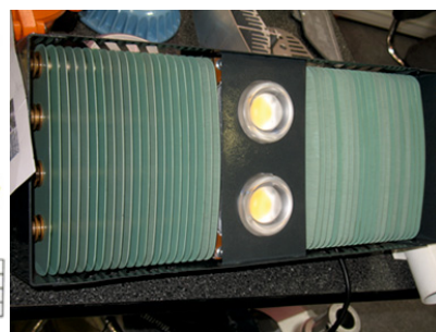
Рис. 22. Светильник с тепловыми трубами. «ЦСОН НАН Беларуси»
