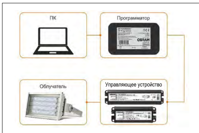
Рис. 5. Общий вид установок для фотобиологических исследований
