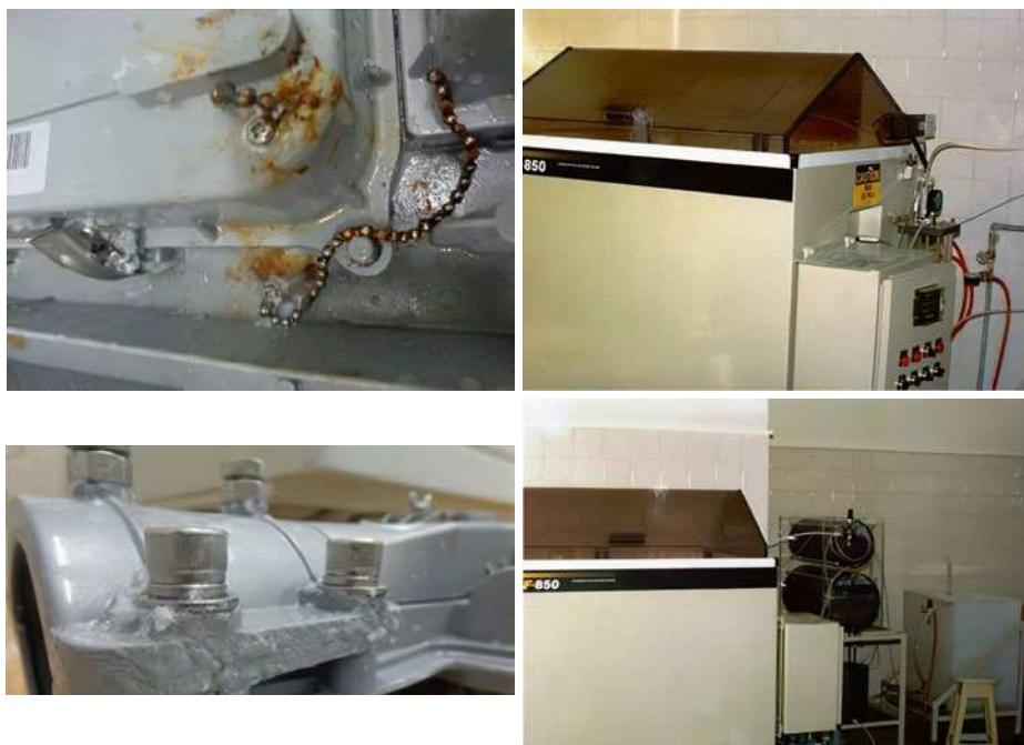
Рис. 3. Оборудование LAL для испытаний брызгами соли и результаты (фотографии автора)
