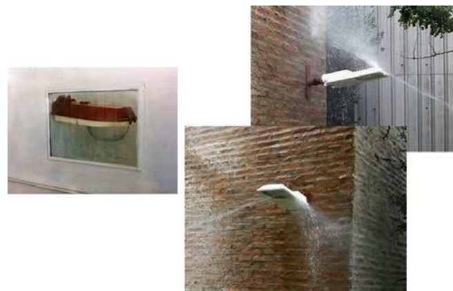
Рис. 3. Оборудование LAL для испытаний брызгами соли и результаты (фотографии автора)
