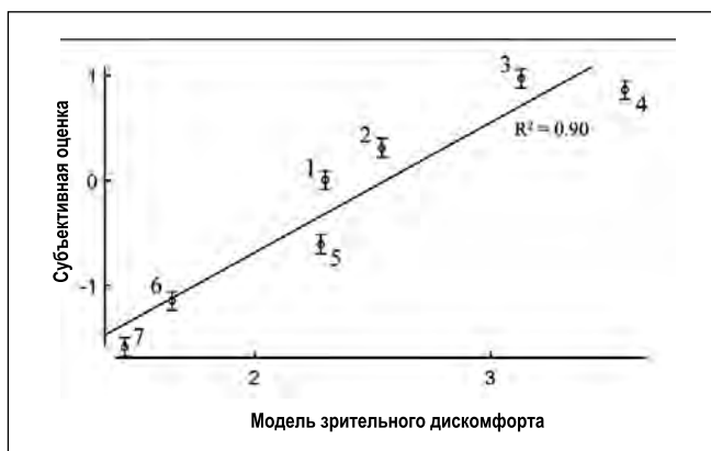
Рис. 5. Парное сравнение субъективных оценок и полученных при помощи модели значений
