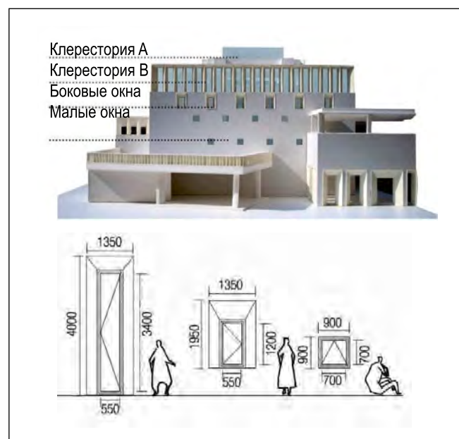
Рис. 1. Физическая модель библиотеки Юйшу (слева) и система окон (справа)
