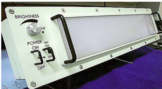
Рис. 9. Светильник со светодиодами для замены светильников с ЛЛ в американских модулях МКС [14]
