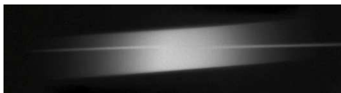
Рис. 6. Изображение ленты лампы при токе нагрева 13,6 А, полученное пирометром. Температура нити (посередине) T_p = 1550 К
