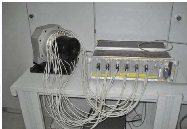
Рис. 1. Калибровочный НМИС. Слева: интегрирующая сфера с СД, установленными вокруг выходного отверстия. Справа: 24-канальный источник питания постоянного тока
