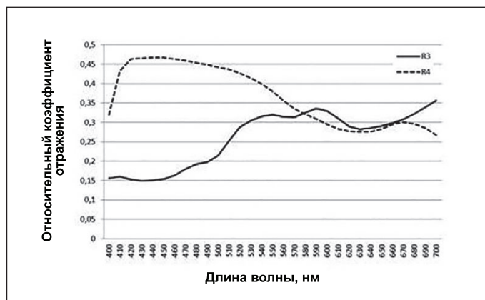
Рис. 2. Спектральные распределения коэффициентов отражения красок R3 и R4
