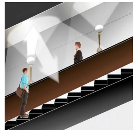
Рис. 5. Предлагаемая схема освещения эскалатора: визуализация принципа освещения эскалаторного наклона
