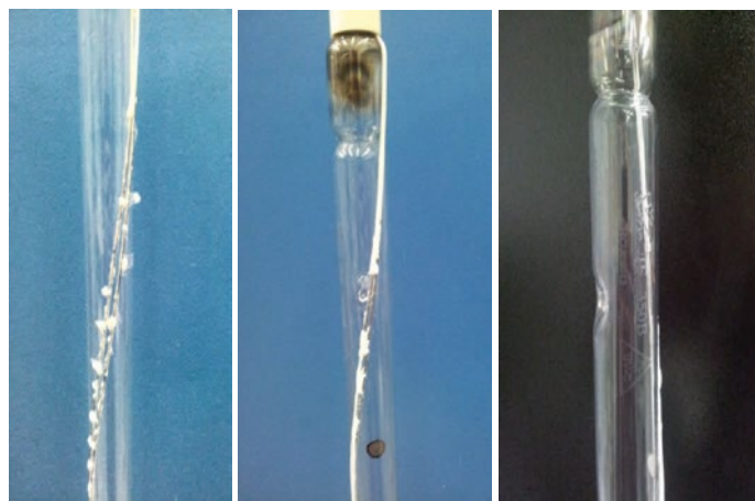
Рис. 4. Вид образца лампы ДБ350В с маркировкой «ЭЛТОС» после наработки в 2000 ч
