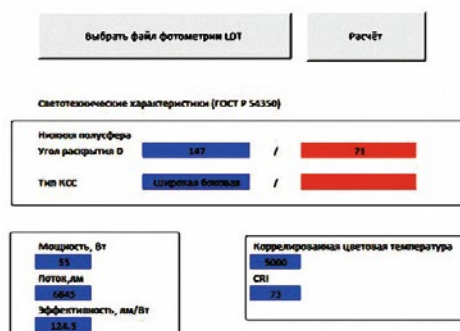
Рис. 2. Интерфейс программы для оценки уровня фотобиологической опасности и распределение силы света ОП (светильник) в декартовых координатах (CRI – общий индекс цветопередачи R_d )
