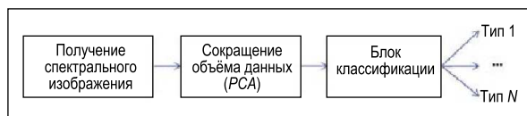
Рис. 8. Схематическое представление основанного на PCA алгоритма классификации, используемого применительно к гиперспектральным данным
