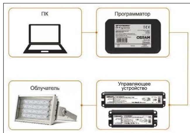
Рис. 2. Блок-схема регулирования параметров фитооблучателей со светодиодами в ФБИ
