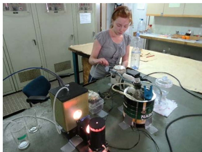
Рис. 2. Измерение показателя поглощения морской воды в судовой лаборатории (морская экспедиция, июль 2016 г.). Слева внизу – спектрофотометр ICAM , справа – фильтрационная установка
