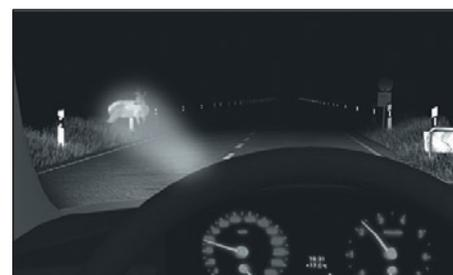
Рис. 5. Принцип маркирующего освещения [5]
