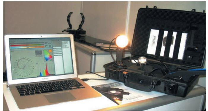
Рис. 27. Переносной спектрогониофотометр. Viso Systems Aps, Дания
