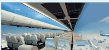
Центре технологический инноваций (*Centre for Process Innovation – CPI*) разрабатывают сверхгибкий дисплей высокого разрешения, который можно использовать для облицовки стен самолётных салонов и показа результатов «живой» съёмки наружными камерами.
