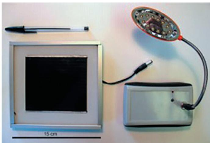
Рис. 1. Лампа с гибкой стойкой и солнечная панель, предлагавшиеся для продажи в рамках исследований. Зарядное устройство (в виде вилки, втыкаемой в розетку), как альтернатива зарядке от солнечной панели, не показано. Для сопоставления размеров показана ручка. Технические характеристики: полезная ёмкость аккумулятора – 1000 мА·ч; полезная энергия аккумулятора – 3,7 Вт·ч; продолжительность работы светильника – 10 ч; максимальная освещённость на расстоянии 1 м – 14 лк; мощность – 1 Вт
