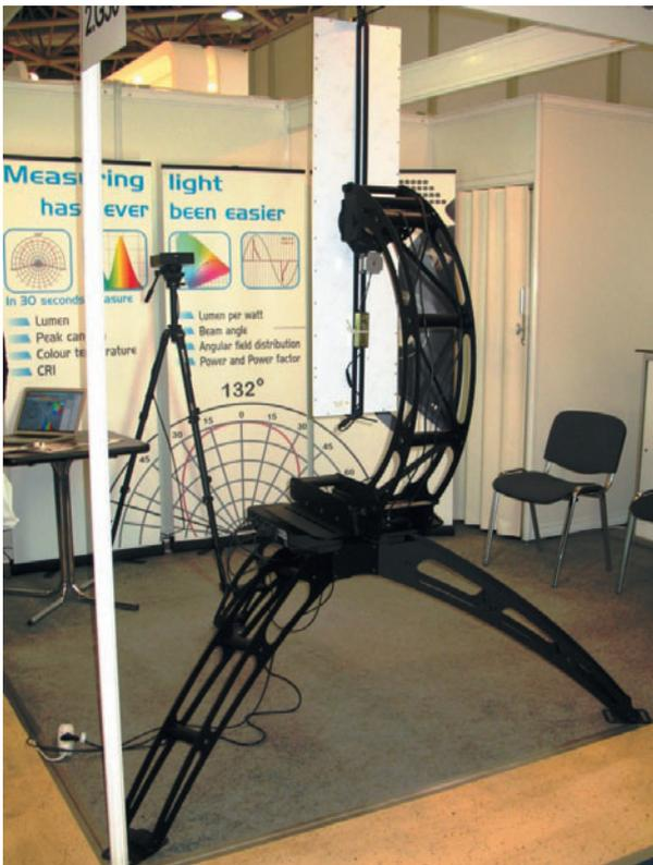
Рис. 26. Стационарный спектрогониофотометр. Viso Systems Aps, Дания
