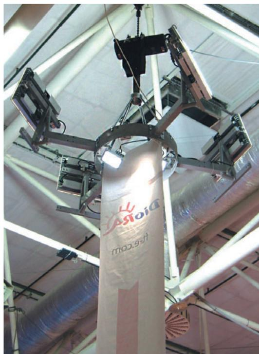
Рис. 16. Мобильный осветительный комплекс мощностью до 2600 Вт. «Физтех-Энерго», Северск
