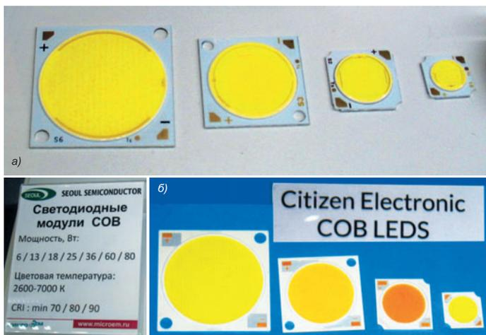
Рис. 7. Мощные светодиодные модули разной мощности. Seoul Semiconductor (Республика Корея) /а/ и Citizen (Япония) /б/
