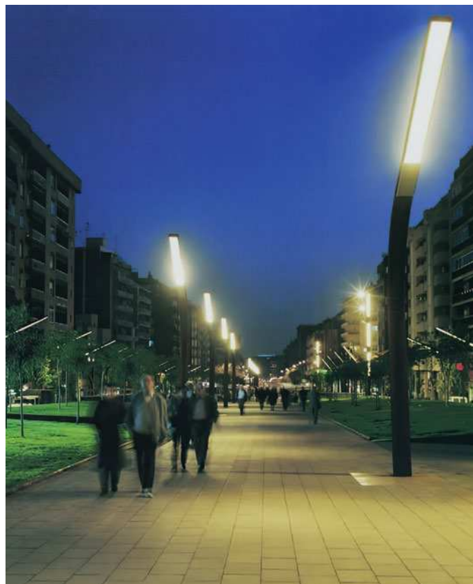
Рис. 8. Освещение центрального проспекта Барселоны плоскими клиновидными световодами в виде светильников наружного мачтового освещения
