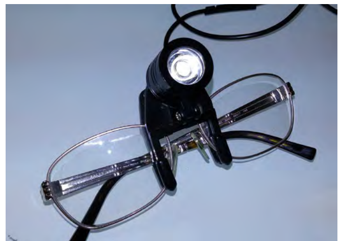
Рис. 4. Налобный светильник со светодиодами
