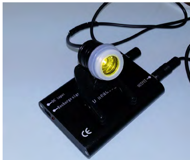
Рис. 5. Цветокорректирующий светофильтр для налобных светильников
