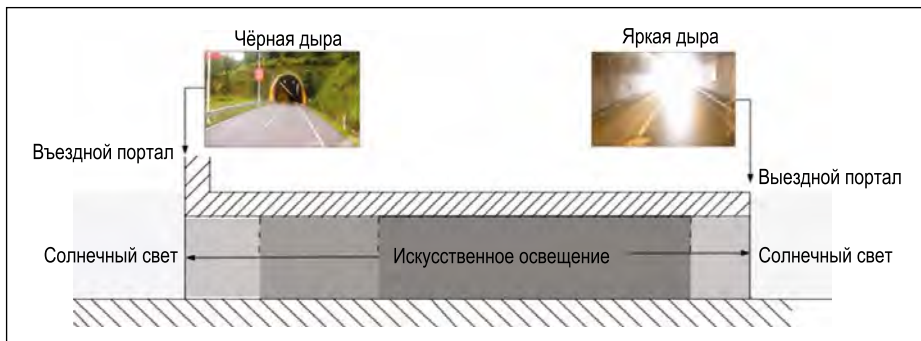
Рис. 2. Тоннель с «чёрной и яркой дырами»
