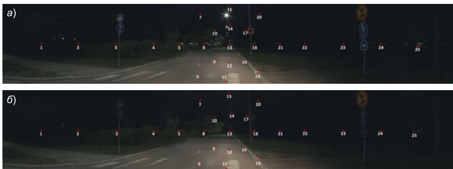
Рис. 3. Местоположения пронумерованных целей на фоновом изображении улицы при наличии (а) и отсутствии (б) ярких точек (светильников с СД)
