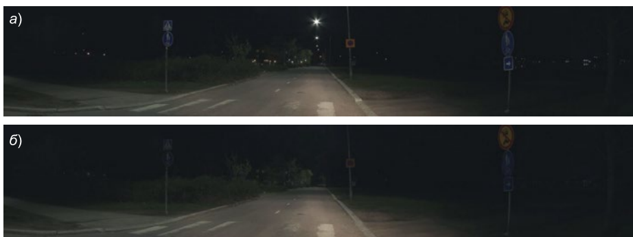
Рис. 2. Фоновые изображения: а – с яркими точками (со светильниками с СД); б – без ярких точек (без светильников с СД)
