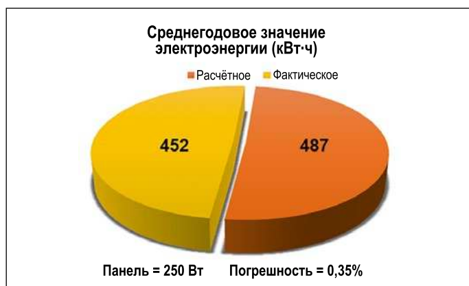
Рис. 6. Расчётное и фактическое среднегодовые значения энергии для панели с оптимальным углом наклона 27^\circ
