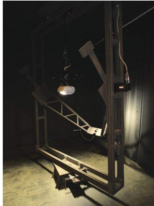
Рис. 7. Гониофотометр RIGO-801, установленный в ИЦ ВНИСИ и использовавшийся для измерения светового потока
