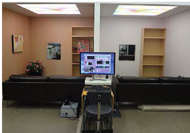
Рис. 1. Две камеры спектрально регулируемой осветительной установки (СРОУ) конструкции НИСТ
