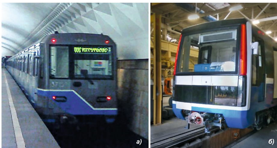
Рис. 5. Внешний вид габаритных огней вагонов 81–760 (а) и 81–722 (б) в рабочем состоянии
