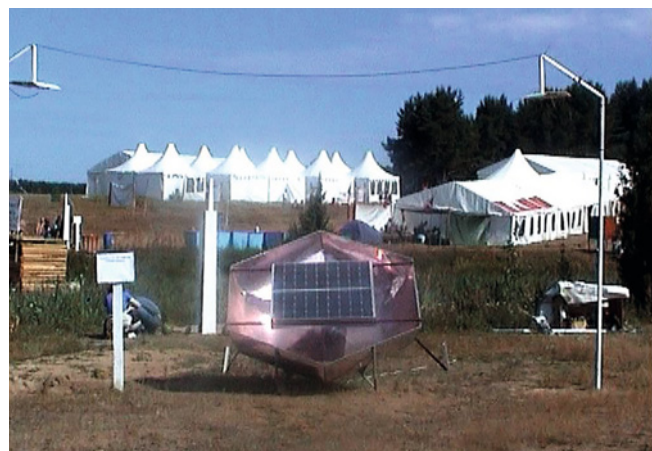
Рис. 4. Стационарный концентратор с солнечной батареей для автономного питания резонансной системы освещения
