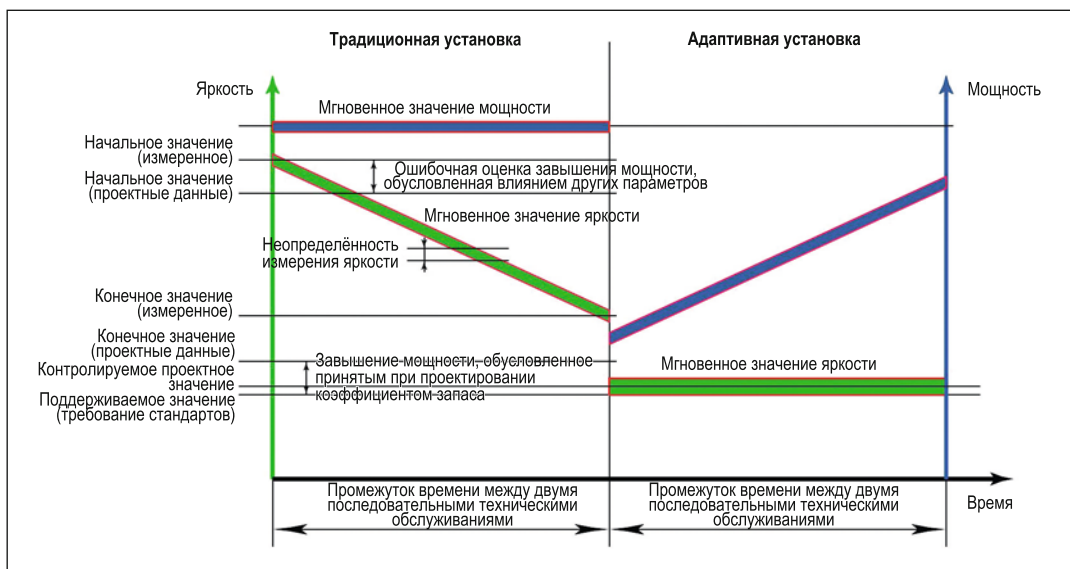
Рис. 1. Сравнение традиционной установки дорожного освещения (слева) и соответствующего адаптивного решения (справа). Для обеих систем показаны временные зависимости яркости и энергопотребления
