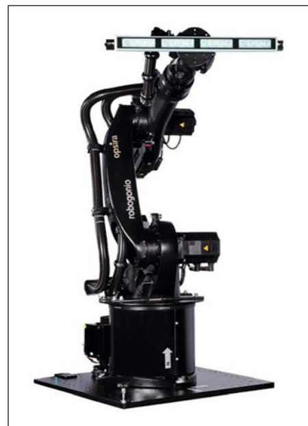
Рис. 5. Гониофотометр типа робогониио
