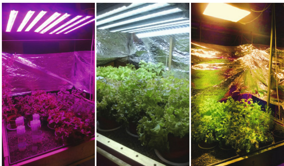
Рис. 5. Фотографии фито-установок, смонтированных для проведения эксперимента в РГАУ – МСХА. Слева направо: с «красно-синими» и белыми облучателями с СД и с облучателями с НЛВД
