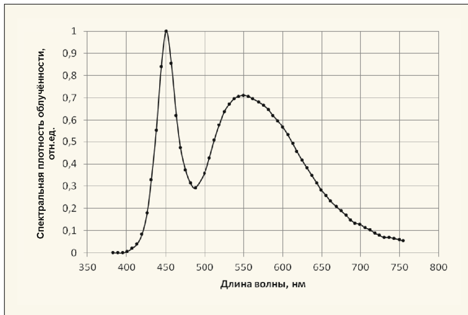
Рис. 3. Относительная спектральная плотность горизонтальной облучённости в 1,5 м от облучателя с белыми СД
