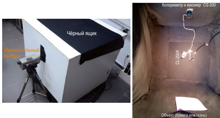
Рис. 1. а – закрытый чёрный ящик и измерительные приборы; б – чёрный ящик без боковой стенки и измерительные приборы
