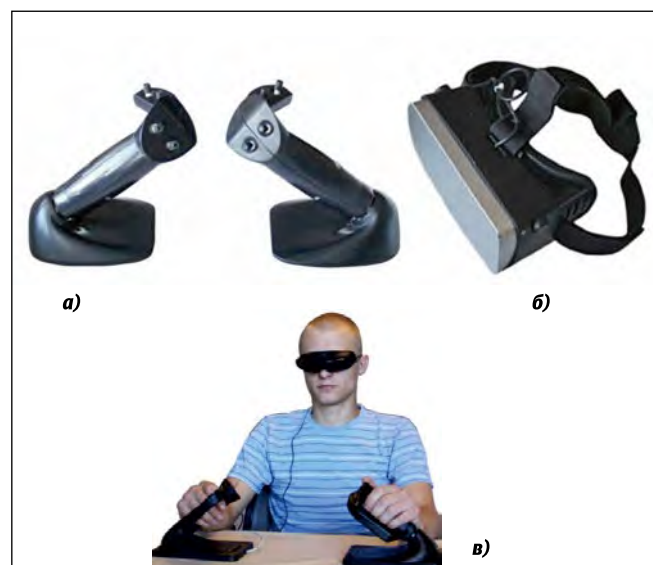
Рис. 4. Унифицированный человеко-машинный интерфейс: а – полиджойстики PD-002; б – видеомаска; в – оператор с новым унифицированным человеко-машинным интерфейсом
