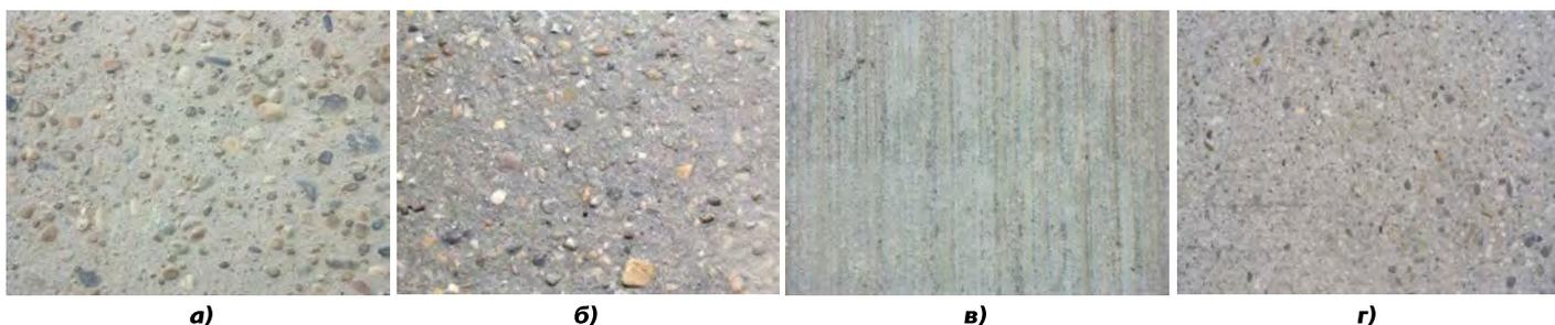
Рис. 6. Фотографии обработанного струёй воды бетона (а – исходное состояние, б – после 2-х лет) и обработанного щёткой бетона (в – исходное состояние, г – после 2-х лет)
