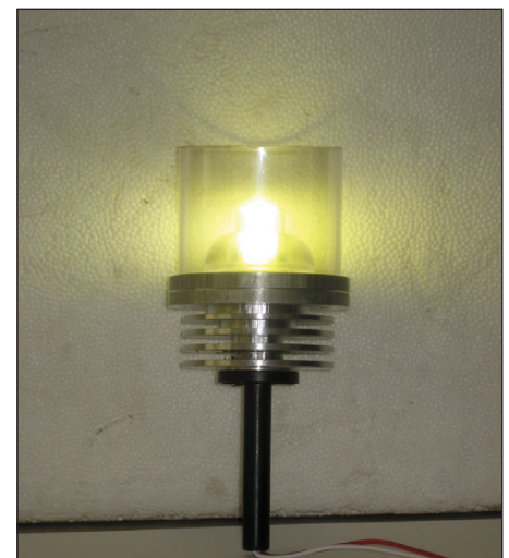
Рис. 5. Внешний вид излучателя типа У-244Бл (для огней навигационных знаков водохранилищ и озёр)
