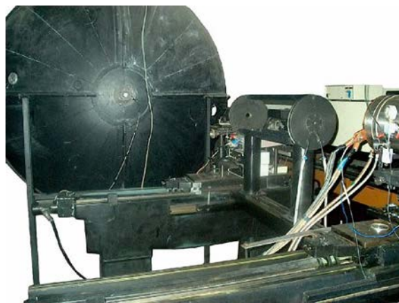
Рис. 1. Государственный первичный эталон единицы силы света и светового потока, ВНИИОФИ, Москва
