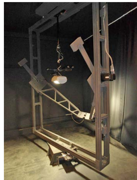
Рис. 4. Гониофотометр ближнего поля типа RIGO 801 (ВНИСИ им. С.И. Вавилова)
