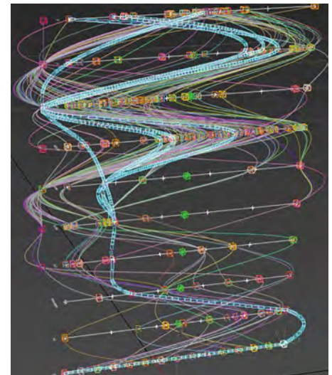
Рис. 3. Диаграмма многомерных данных, связывающая условия и методы формования объёмных ММК Al/SiC с основными свойствами материалов (КТ и КТЛР) для сравнения собственных экспериментальных данных со сведениями из литературных источников
