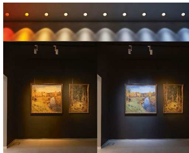
Рис. 2. Пример использования технологии tunable white в освещении картин: слева КЦТ около 3000 К, справа – около 4000 К
