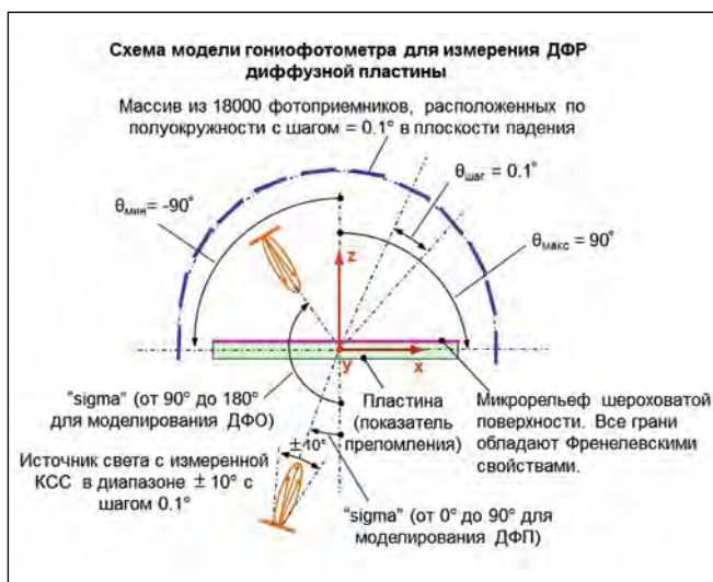
Рис. 3. Схема модели гониофотометра для измерения ДФР диффузной пластины
