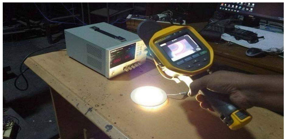
Рис. 1. Температурные измерения СДМ без УУ с помощью тепловизора («Fluke» Ti 400)
