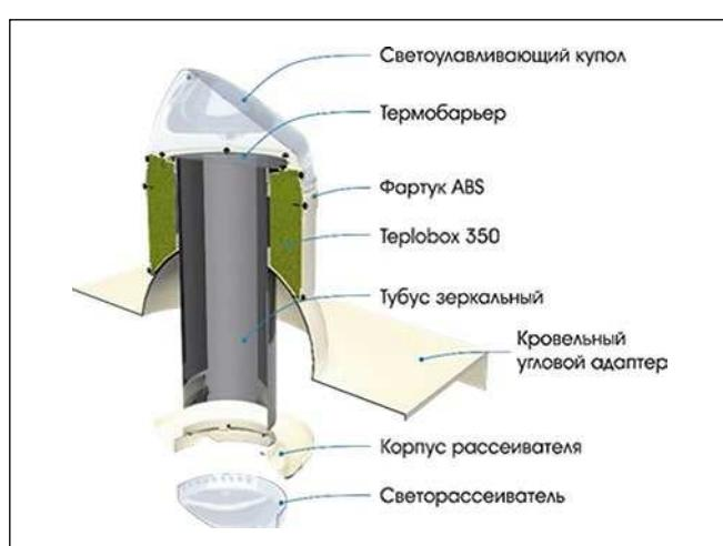
Рис. 1. Схематический вид разработанной системы естественного освещения «Solarway»
