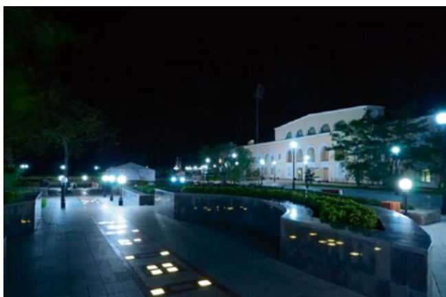
Рис. 5. Освещение пешеходной площади в зоне фонтана со светодиодными модулями в мощении. Фото В. Е. Карпенко
