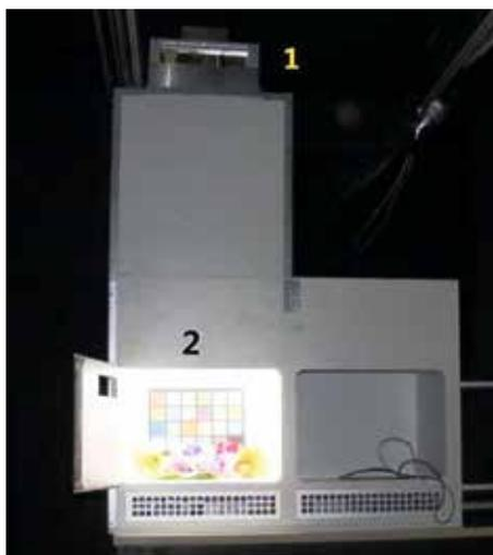
Рис. 2. Белая камера просмотрной кабины. Использовалась только одна камера (поз. 2), которая содержала комбинацию искусственных объектов (одна комбинация в конкретный момент времени, здесь показана комбинация «многоцветных» объектов). Наверху просмотрной кабины находился СД-источник света (поз. 1). Уровень яркости –  $(743 \pm 9) \text{ кд/м}^2$
