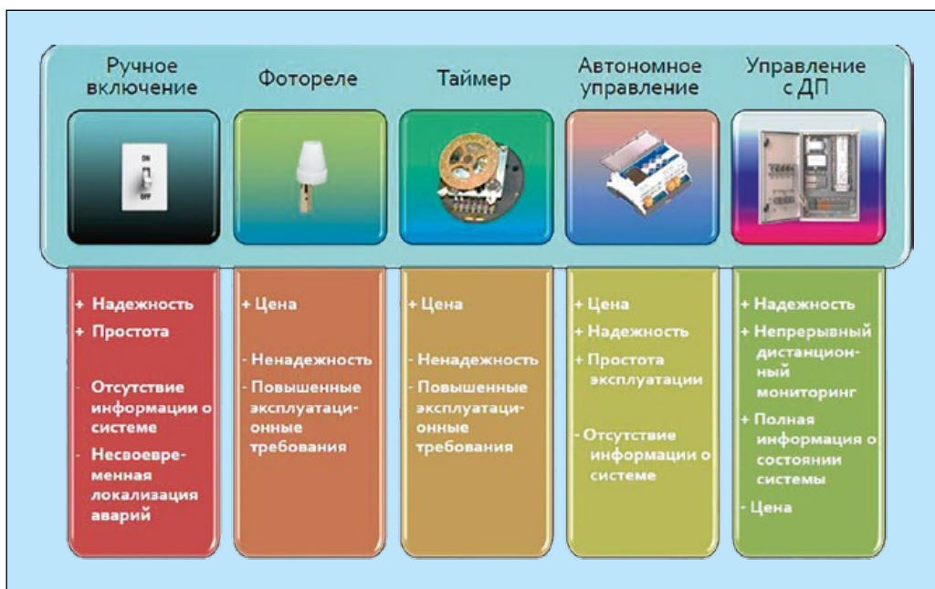
Рис. 1. Достоинства (+) и недостатки (-) применяемых сегодня способов и систем управления освещением
