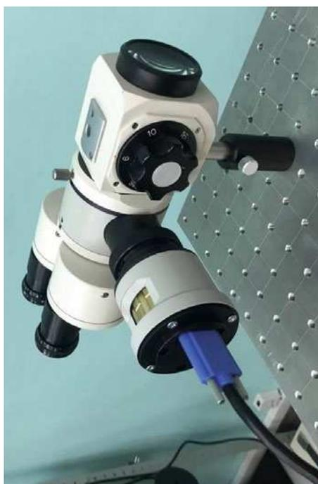
Рис. 2. Видеосистема, присоединённая к одному из каналов стереомикроскопа *Huvitz 2*
