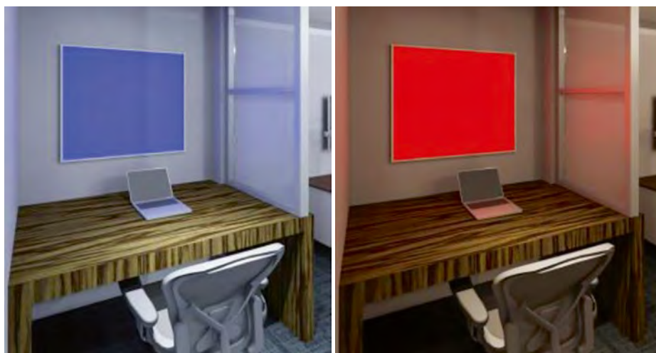
Рис. 7. Пример использования самосветящейся дисплейной панели для создания циркадно эффективного (синего) или циркадно неэффективного (красного) света в зависимости от времени суток
